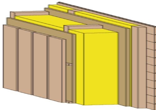
Die Außenwände vom **Holzhaus TO GO** werden wahlweise in Holzriegelbauweise hergestellt und mit einer nicht brennbaren Wärmedämmung ausgestattet oder gegen Mehrpreis als Holz-Massivwand mit außenliegender Holzfaserdämmung hergestellt.
