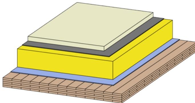
Die Dachkonstruktion wird aus **Fichten- Massivholzdielen** angefertigt. An der Innenseite bleibt die Dachkonstruktion als gehobelte, naturbelassene Holzoberfläche sichtbar.
